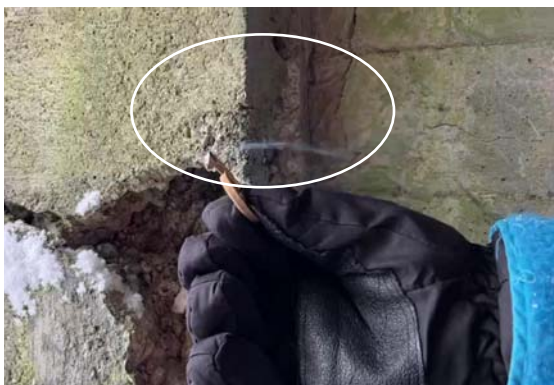
図1 冷風穴(2号倉庫)で外気が地下へ吸い込まれていく様子(上映動画より)
